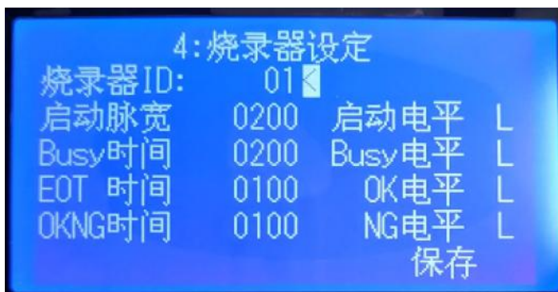
图 35. 烧录器电平及持续时间设置参考
